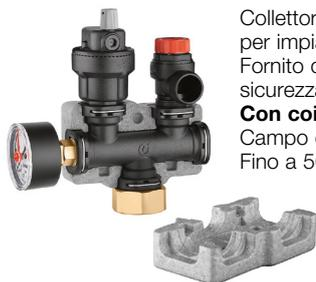
Collettore portastrumenti in tecnopolimero per impianti di riscaldamento. Fornito di valvola sfogo aria, valvola di sicurezza in tecnopolimero e manometro. **Con coibentazione.** Campo di temperatura: 5–90 °C. Fino a 50 kW.
