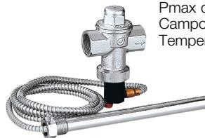
Valvola di scarico di sicurezza termica, con sensore a doppia sicurezza, per generatori a combustibile solido. Pmax di esercizio: 10 bar. Campo di temperatura: 5–110 °C. Temperatura di taratura 98 °C (0/-4 °C).
