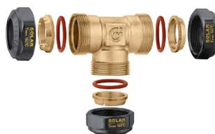
Raccordo a tee, meccanico a tenuta O-Ring per impianti solari. Per tubi in rame ricotto, rame crudo, ottone, acciaio dolce e acciaio inox. Pmax di esercizio: 16 bar.
